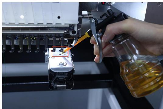
在机器开机状态下，将机器换色到第 1 针。对旋梭座的前注油孔添加适量的润滑机油
