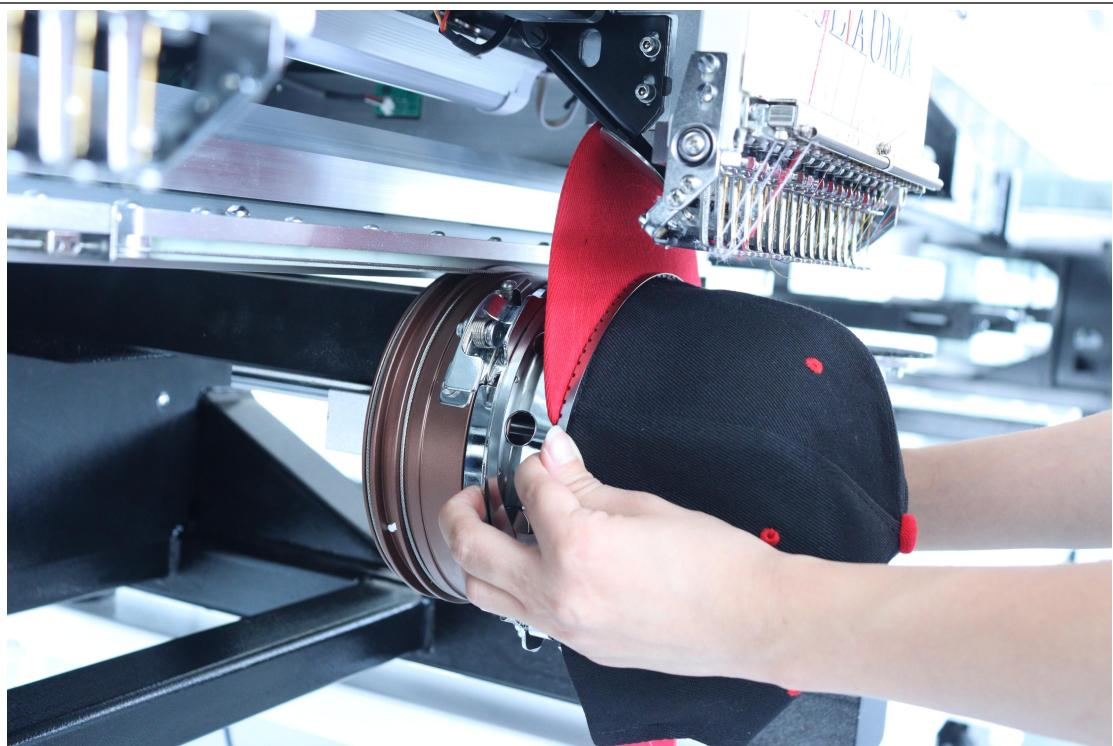
最后将帽子固定在机器的帽绣装置上。请注意帽驱动的三个卡扣必须完全卡住帽框，使帽框不能松动。
