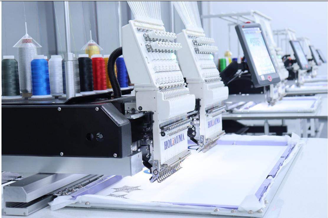
设置完成后，确认绣框移动到机器的居中位置，即可开始进行机器的平绣刺绣工作。
