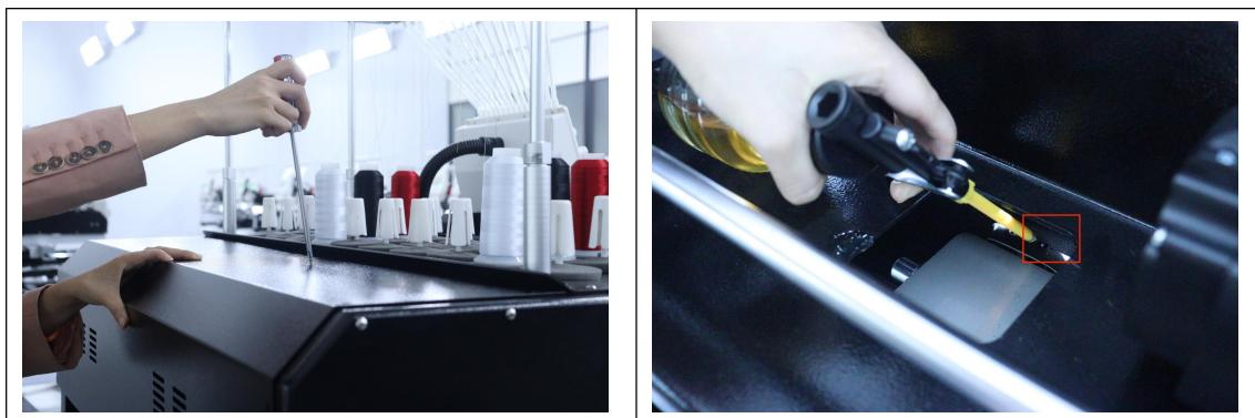
使用十字螺丝刀卸下机器的后盖板，对旋梭座上的后注油孔添加适量的润滑机油。
