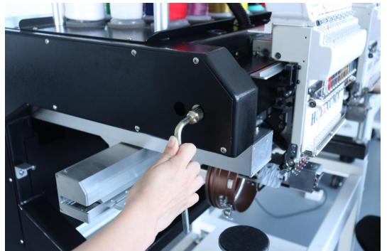
当机器主轴停留在 200 度时，调整帽绣针板直至确认针完全在针板孔的居中位置，固定针板。
