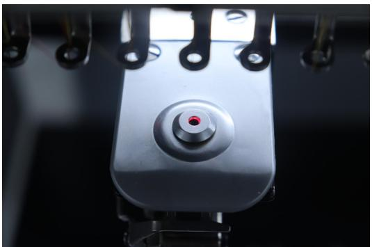
使用 2mm 的六角螺丝，松开红光定位装置的底部螺丝，调整红光定位装置的上下位置。
