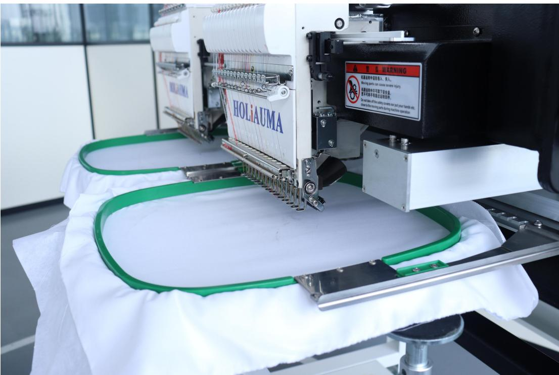
设置完成后，确认成衣绣框移动到机器的居中位置，即可开始进行机器的成衣刺绣工作。
