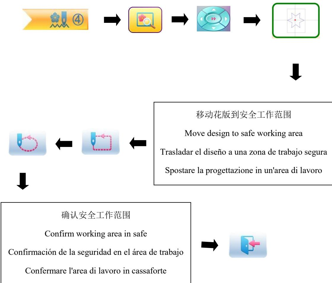
⚠ 请务必进行花样刺绣安全范围检测，包含花样周边范围检测和花样轮廓范围检测。如目测发现刺绣区域位置超出绣框安全范围或机器出现红色警戒，请重新定位刺绣区域。（如果缺失此步骤，机器会很大可能出现严重的人为损坏事故）
